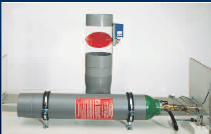
Löschmittelbehälter mit Schnellschlußventil, Schlaucharmatur, Anschlußdose sowie pyrotechnisch / elektrisch ansteuerbare Auslöseeinrichtung (Druckgasgenerator)
