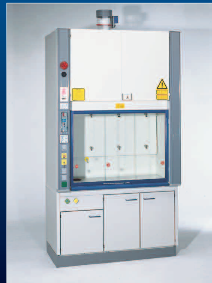
Laborabzug mit vollautomatischer GLORIA Argonlöschanlage (mit zusätzlicher manueller Auslösung sowie optischer und akustischer Alarmmierung, automatisches Schließen des Frontschiebers, der Abluftklappe und der Medienzuleitungen).
